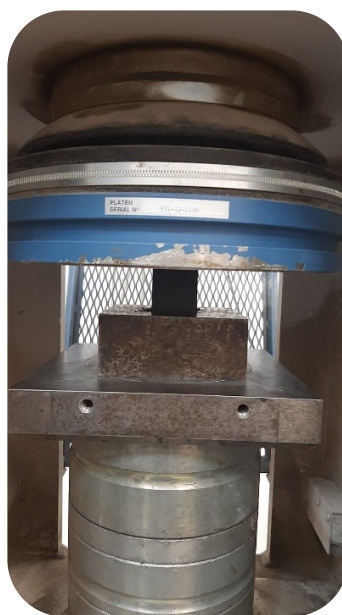
Figura 15: Ensaio de compressão.
