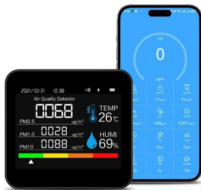
Slika 5. Kućni senzor za snimanje kvaliteta vazduha i mobilni uređaj za prikazivanje podataka sa pripadajućom aplikacijom.
